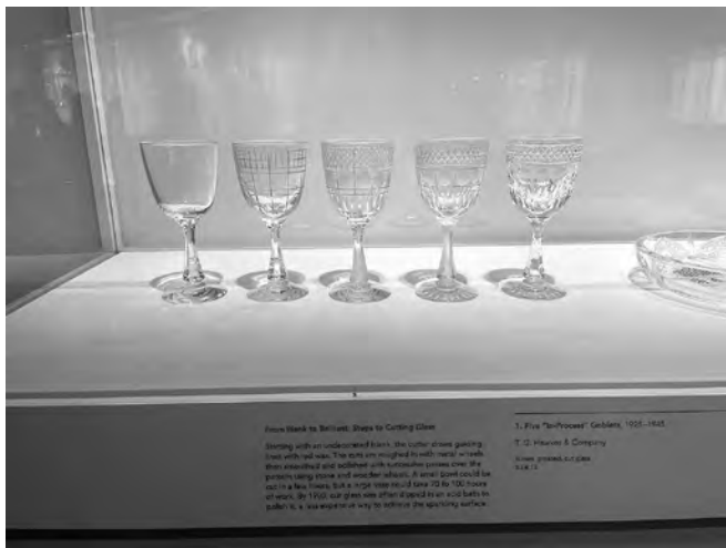
図19 クリスタルカットガラスの制作工程
